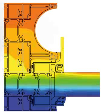
**Sistema scorrevole per serramenti a taglio termico con ridottissima mostra architettonica.**
